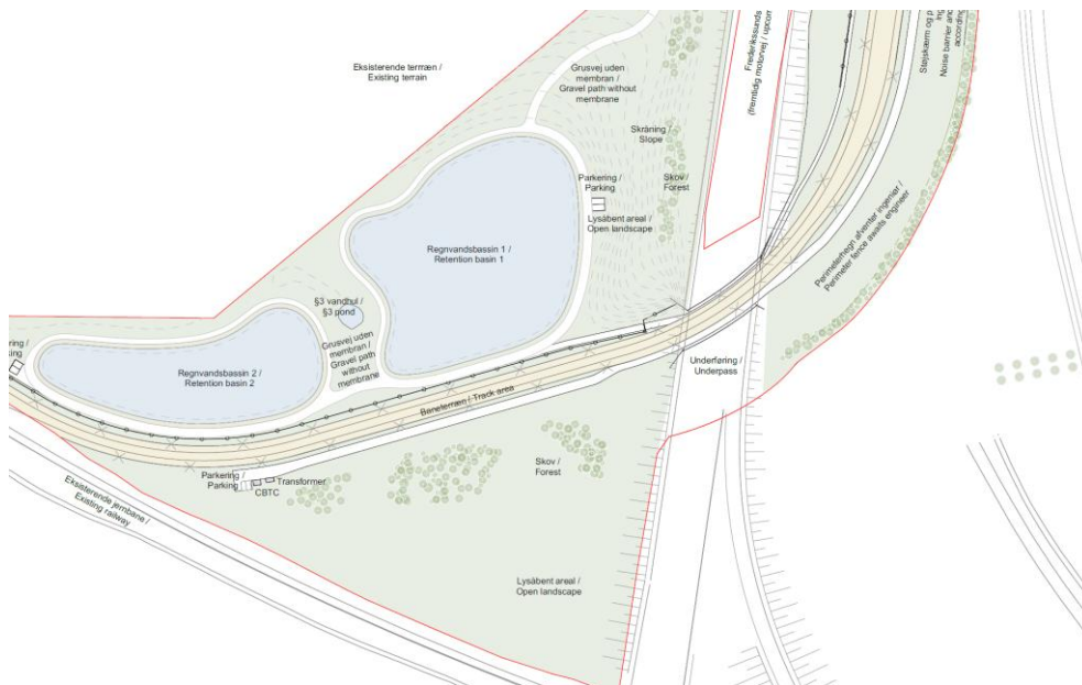
Figur 4-14 Skitse for underføring af bane under Frederikssundsvej, med to spor, en trampesti og en servicevej.
