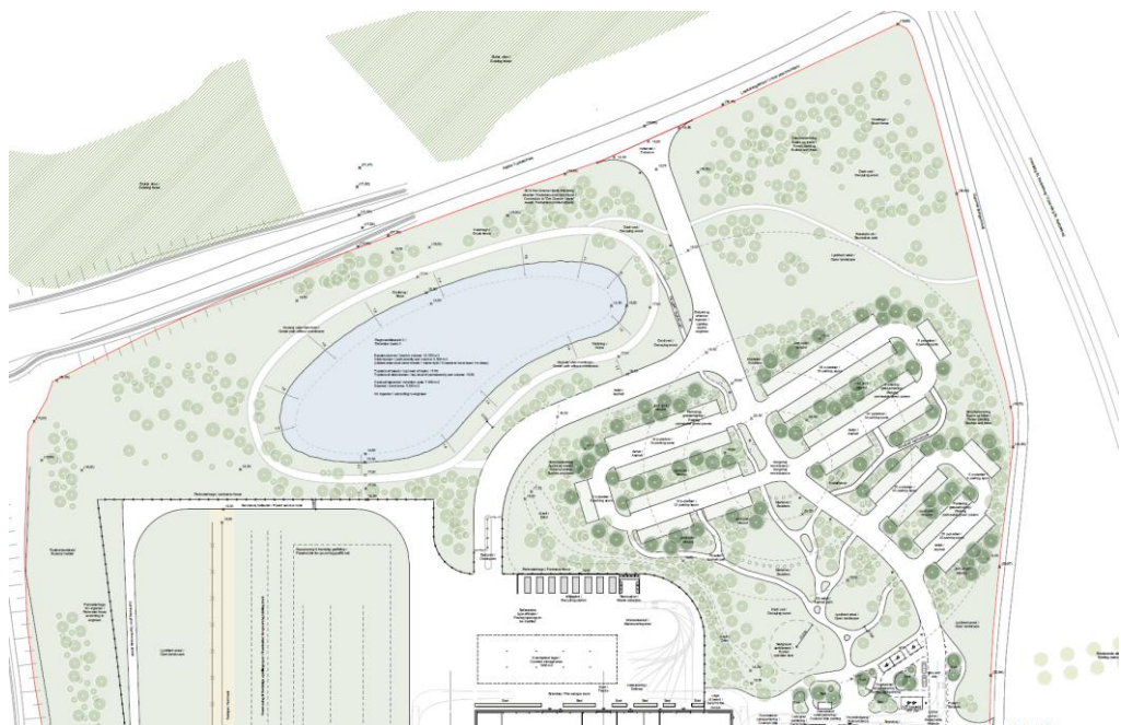
Figur 4-17 Det nordlige regnvandsbassin med udledning til Sillebro Å.
