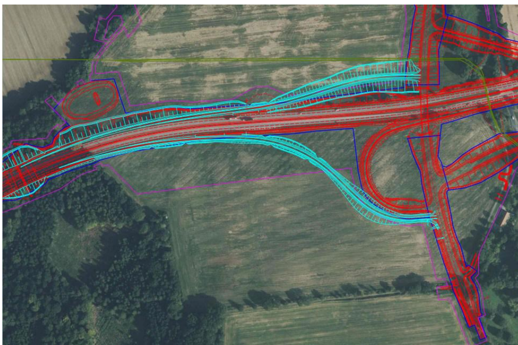
Figur 1: Skitse af projektændringen og placering (med turkis markering i billedet) af de vestvendte til- og frakørselsramper syd for Knabstrup By
