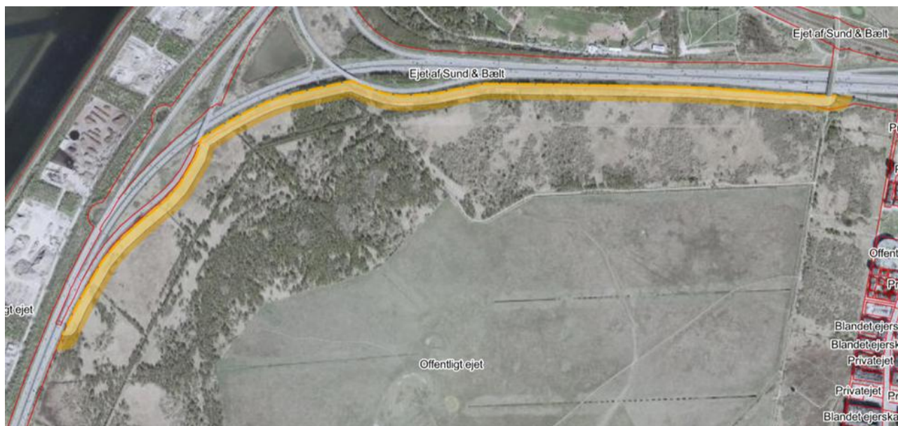
Figur 1: Støjvoldens fodaftryk er indtegnet med hhv. 30 meters dybde (inderste gule markering) og 45 meters dybde (orange markering).
