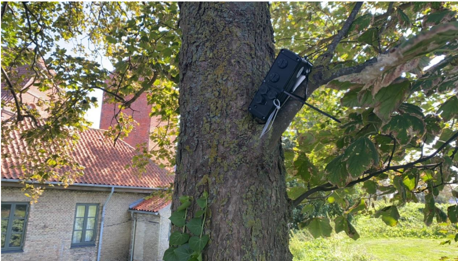
Figur 2-2: Fysisk opsætning af flagermusdetektor Peterson D500X på projektet.
