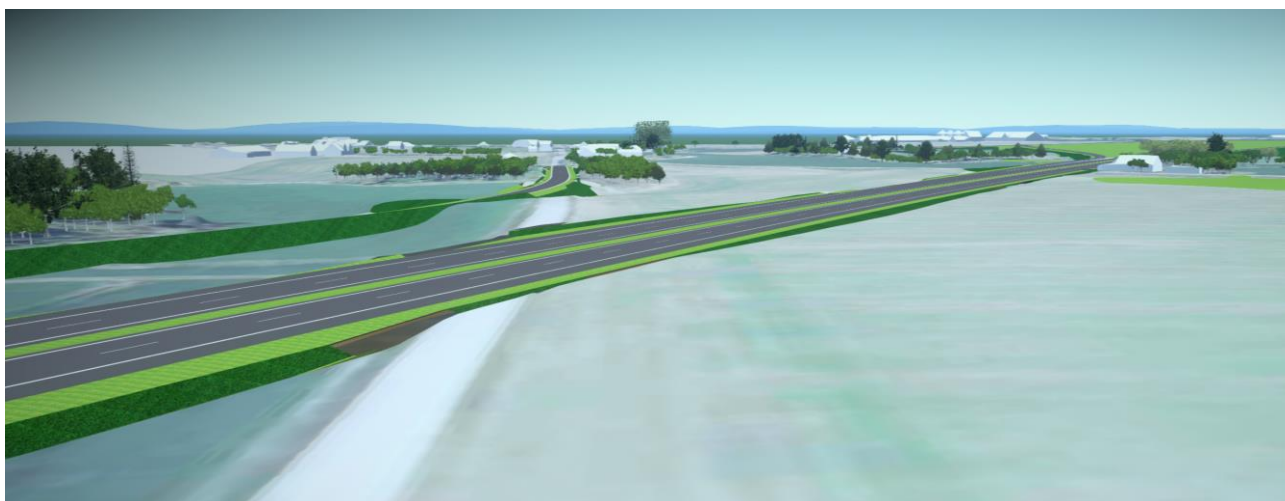
Figur 2.3: Visualisering, der viser forlægningen af Skivevej samt motorvejens forløb tværs gennem landskabet og på tværs af Skivevejs eksisterende linjeføring. I det oprindelige projektforslag ligger motorvejen på dæmning, og bryder i høj grad de visuelle relationer på tværs af landskabet. I det reviderede projekt ligger motorvejen omkring eksisterende terræn og fremstår derved i mindre grad som en visuel barriere for udsigterne på tværs af landskabet.
