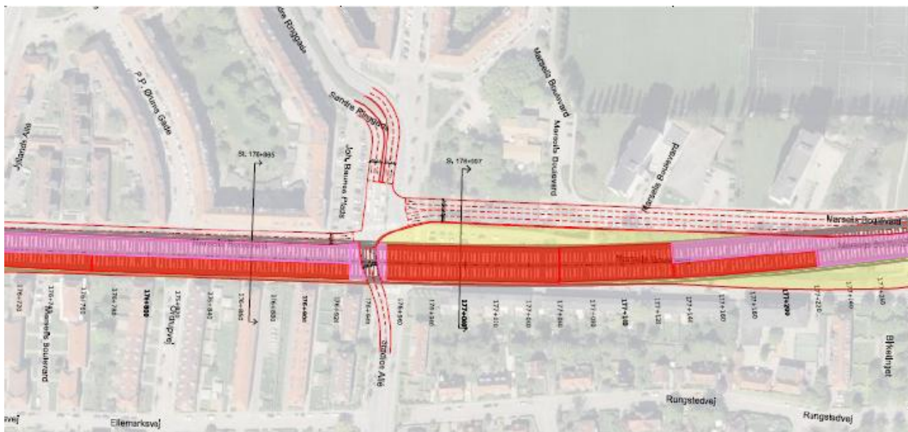
Figur 4: Ændret krydsombygning i den mere østlige del af Marselis Boulevard, hvor det muliggøres at beholde fire spor på vejen mens anlægsprojektet er i gang.
