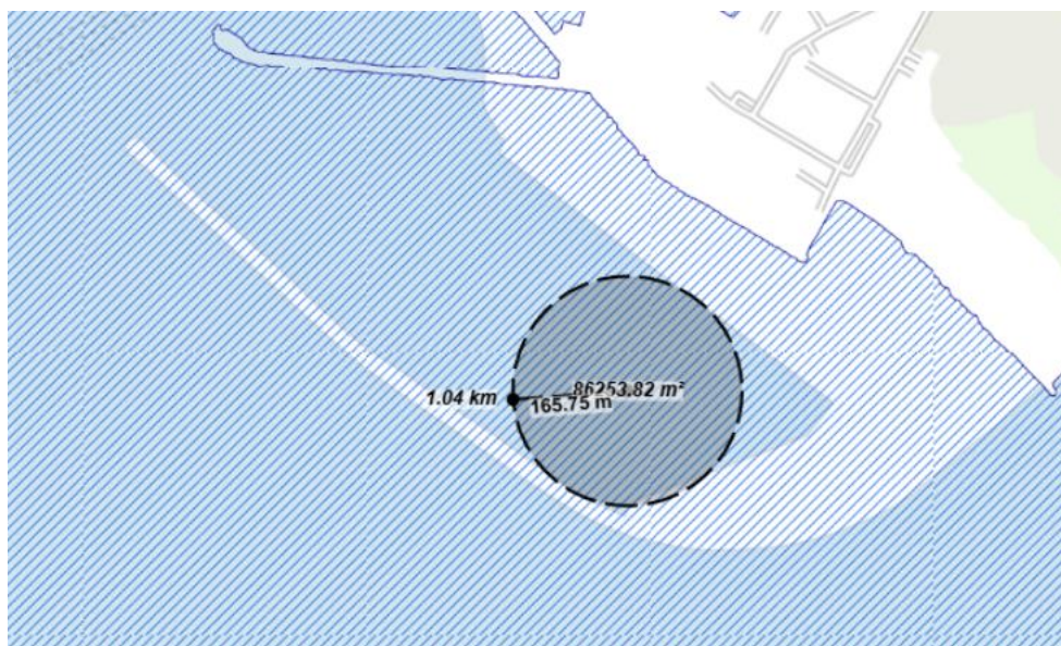
Figur 4.4: Tegnet cirkel med radius på ca. 165 meter i industribassinet. I en afstand af ca. 165 meter overholdes det generelle miljøkvalitetskrav for benz(a)anthracen og pyren . Blå skravering angiver afgrænsningen af vandområde nr. 56.
