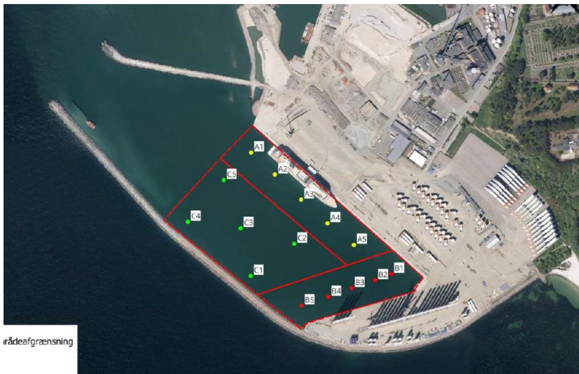
Figur 3.1: Prøvetagning i Rønne Havn industribassin med angivelse af delprøver i område A, B og C.
