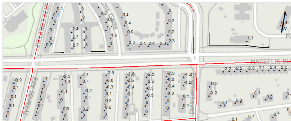
Figur 5 Forskel i opnået støjreduktion ved ny vej placeret i de to sydlige spor i stedet for i midten af Marselis Boulevard.
