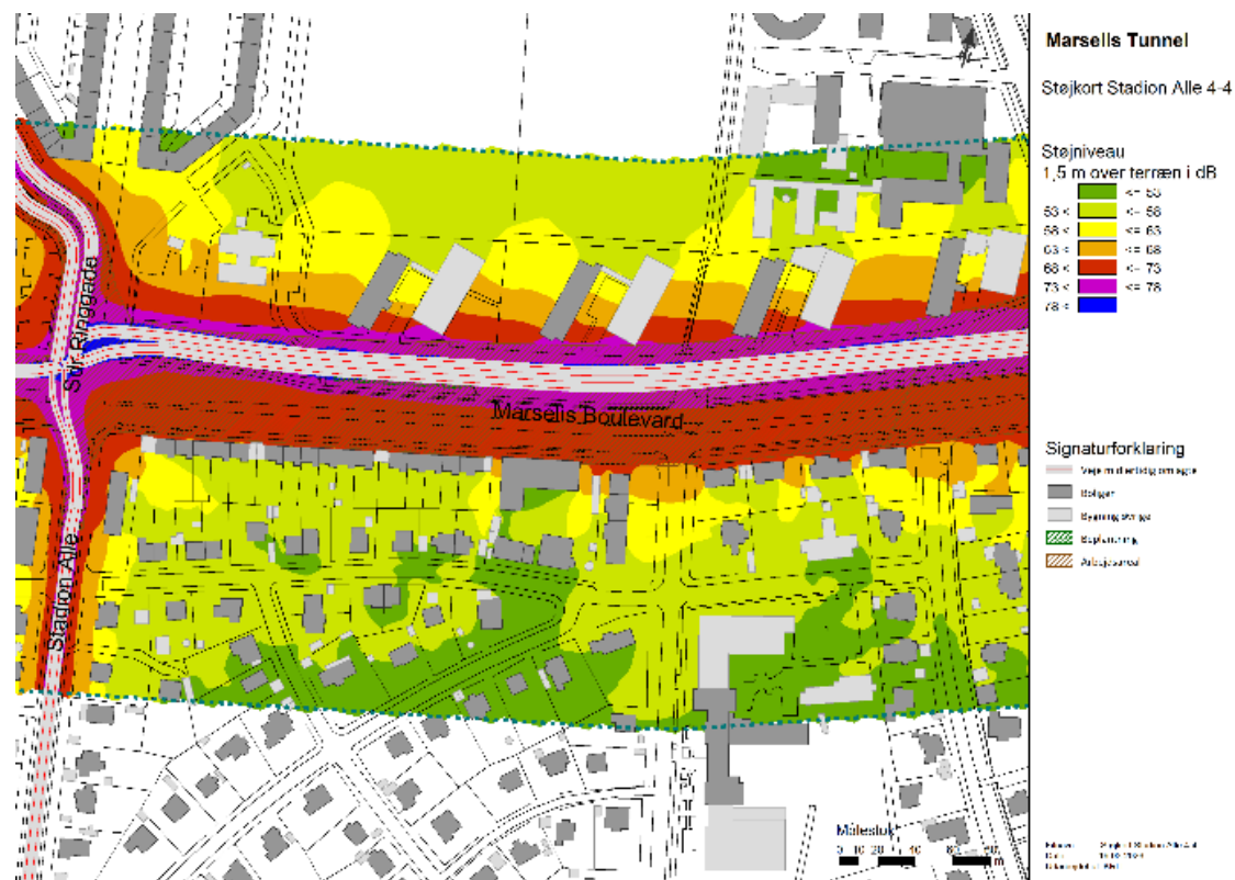
Figur 23 Kort der viser den absolutte støjpåvirkning i projektændringen hvor vejen i den nordlige del af anlægsområdet kan fastholdes med fire spor.
