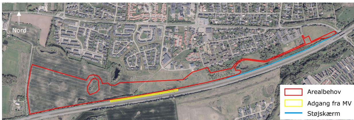
Figur 9 Kort der viser arealbehovet i anlægsfasen ved støjvolden ved Stavtrup med rødt, samt det areal på motorvejen hvorfra der via vigesporet anlægges en mere effektiv vejadgang i anlægsfasen. Med blå er vist støjskærmen.
