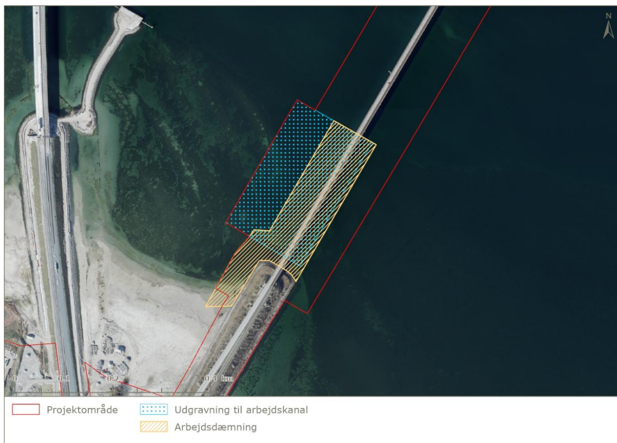
Figur 4-10: Areal for hhv. arbejdsdæmning og arbejds kanal ved Falster. Det er op til entreprenøren at vælge metode og dermed hvor langt ud arbejdsdæmningen skal bygges og dermed hvor meget arbejds kanal der vil være behov for. Dog er det bestemt at første brofag tages ned fra arbejdsdæmning.
