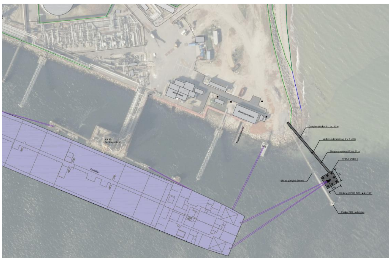
Figur 1: Placering for den nye duc d'albe, med et indtegnet skib som eksempel for fortøjningsmulighederne på kajen ved den nye duc d'albe.
